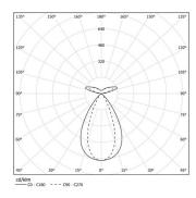
Angle du faisceau Flood 64° / batwing
