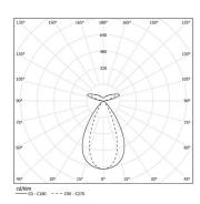
Angle du faisceau Flood 64° / batwing
