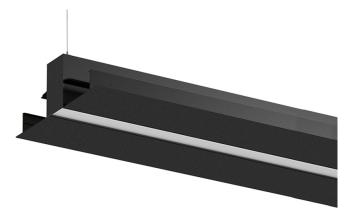
Conception : Eduardo Souto de Moura Luminaire suspendu doté d'un boîtier en profilé en aluminium avec anodisation de 25 microns de résistance maximale à la corrosion avec peinture électrostatique 100 % polyester en finition texturée. Diffuseur en plexiglas opaque avec un système d'encliquetage facile à utiliser.
