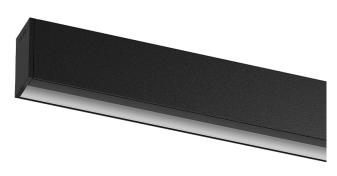
Conception : OM + Bartenbach GmbH Luminaire en applique ou suspendu doté d'un boîtier en aluminium avec anodisation de 25 microns de résistance maximale à la corrosion en finition mate ou peinture électrostatique 100 % polyester en finition texturée.
