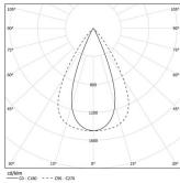
Angle du faisceau Flood 64° Application Poids
