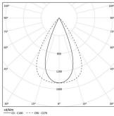
Angle du faisceau Flood 64° Application Poids
