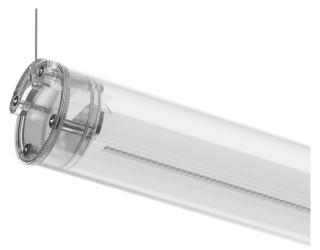
Diseño: Eduardo Souto de Moura Luminaria de suspensión con cuerpo tubular de PMMA semiesmerilado de 70 mm de diámetro. Tapas de policarbonato transparente con ángulos de instalación marcados.
