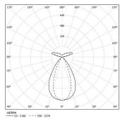
Abstrahlwinkel Flood 64° / batwing Anwendung
