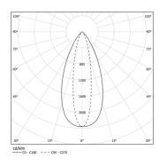
Abstrahlwinkel Elliptical 22×47° Anwendung
