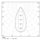
Abstrahlwinkel Elliptical 22×47° Anwendung
