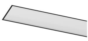
Einbauleuchte mit Gehäuse aus Aluminiumprofil mit 25 Mikron-Eloxierung für maximale Korrosionsbeständigkeit in matter Ausführung oder mit elektrostatischer 100% Polyesterlackierung in strukturierter Ausführung. Diffusor aus satiniertem Polycarbonat mit bedienerfreundlichem Klemmsystem. Endteile aus eloxiertem Aluminium in matter
